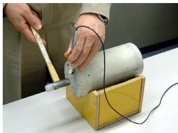
円柱供試体の弾性波速度測定状況
